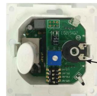
**Совет.** Перед установкой ручки настройки температуры поверните потенциометр по часовой стрелке до упора. В этом случае ручка зафиксируется в положении 9.
