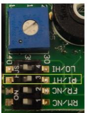
DIP-переключатель 3 в правом положении. DIP-переключатель 4 в положении, соответствующем нагрузке термостата (см. п. 1). Положение остальных DIP-переключателей не имеет значения.
