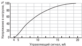
Рис. 4 Зависимость выходного напряжения от входного сигнала 4-20мА
