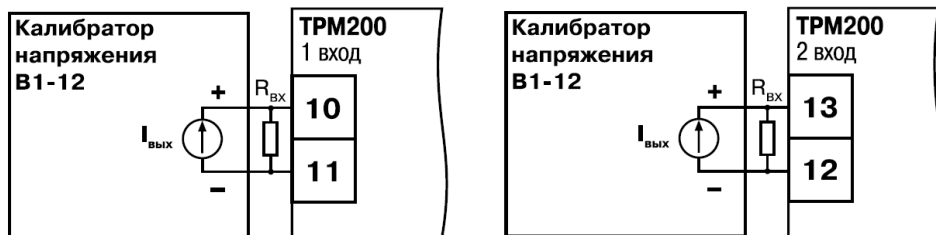
Рисунок Ж.3 ( R_{\text{вх}} = 100 \text{ Ом} \pm 0,1\% )
